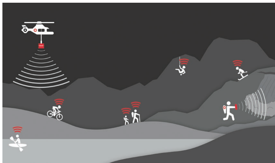
Mittels Detektor können die Reflektoren aus der Luft geortet werden.
